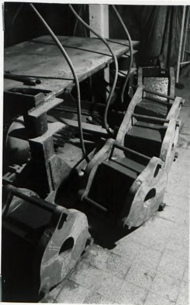
Fot.10. Badanie wodoszczelności próbek kostkowych.
