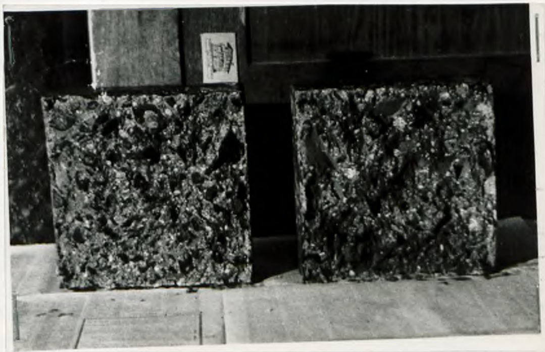
Fot.12. Przełom próbek kostkowych po badaniu wodoszczelności.
