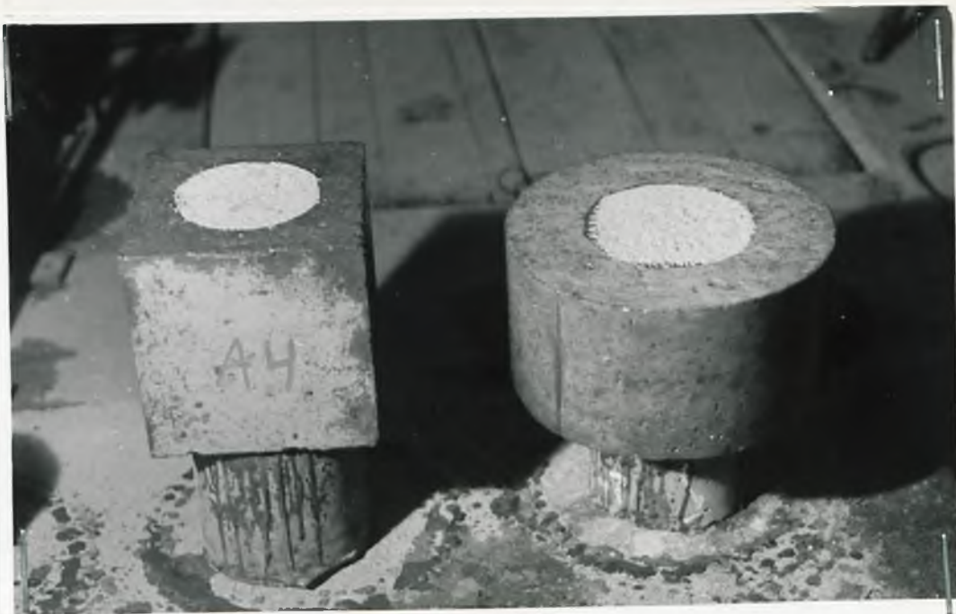
Fot.5. Próbki betonowe z zaimpregnowaną powierzchnią.
