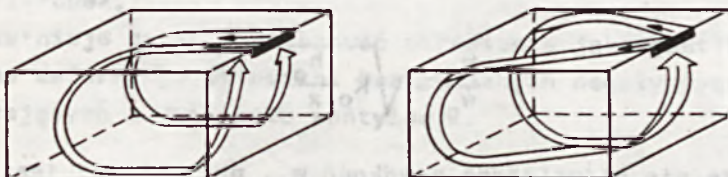
Rys.20. Cyrkulacja w niskich pomieszczeniach przy zaokrąglonych pojedynczych nawiewach \frac{B}{H} > 1 [26]
