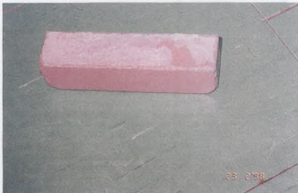
Rys. 19. Próbki zawiesiny zarobionej 1% roztworem \text{Na}_2\text{SO}_4 po 82 dobach przechowywania w tym roztworze; wiek próbki – 90 dni. Widoczne zmiany na górnej, zacieranej powierzchni
