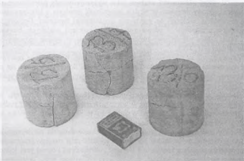
Rys. 5. Głębokie, wskrośne pęknięcia próbek zawiesiny po cyklicznym zamrażaniu
