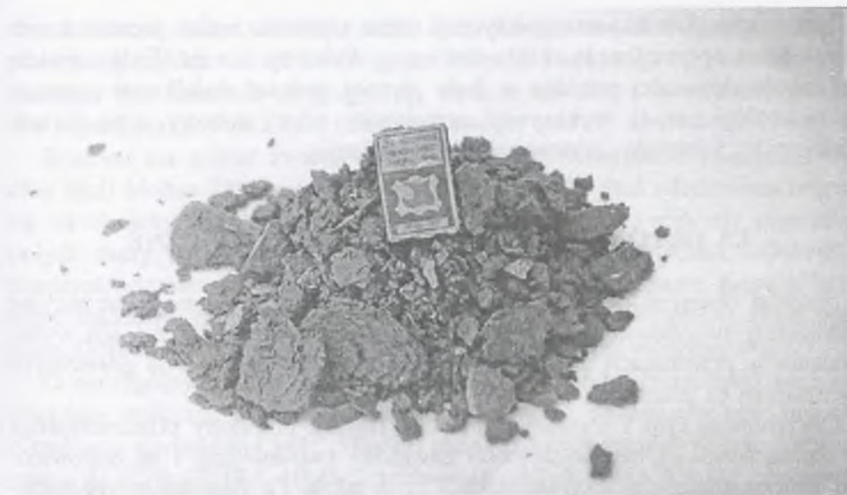
Rys. 7. Rozpad zawiesiny w wyniku przemiennego zamrażania
