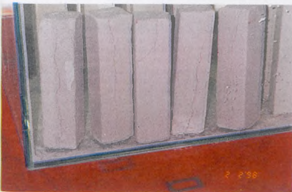
Rys. 17. Próbkki zawiesziny zarobionej wodą wodociagową po 48 dniach przechowywania w 1% roztworze \text{Na}_2\text{SO}_4 ; wiek próbek – 55 dni
