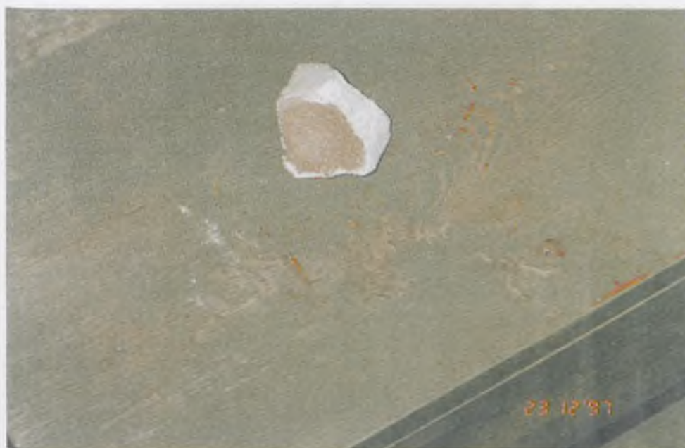
Rys. 13. Fragment próbki zawiesiny zarobionej 1% roztworem \text{Mg}(\text{NO}_3)_2 po 20 dniach przechowywania w tym roztworze; wiek próbki – 28 dni
