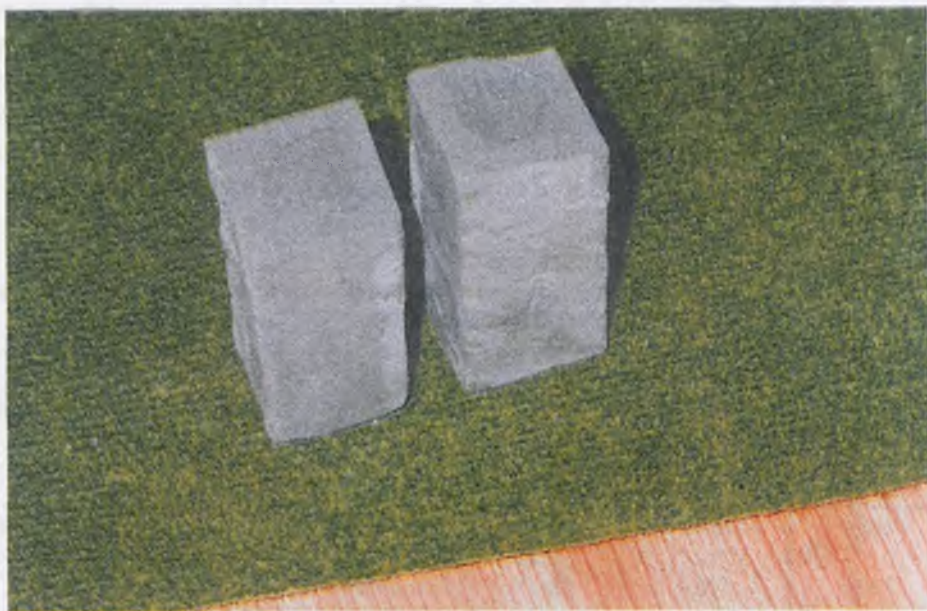
Rys. 35. Przelom próbki zawiesiny cementowo-bentonitowo-popiołowo-wodnej po 90 dniach dojrzewania, w tym 76 dniach przechowywania w 1% roztworze \text{Na}_2\text{SO}_4 . Widoczne różnice w strukturze zawiesiny: jaśniejsze i bardziej zwarte obrzeża, ciemniejsze i bardziej porowate i wilgotne jądro przelomu
