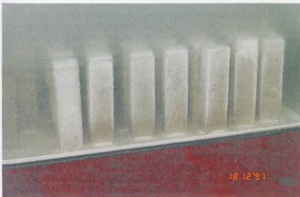
Rys. 12. Próbkki zawiesiny zarobionej 1% roztworem \text{Mg}(\text{NO}_3)_2 po 16 dniach przechowywania w tym roztworze; wiek próbek – 24 dni
