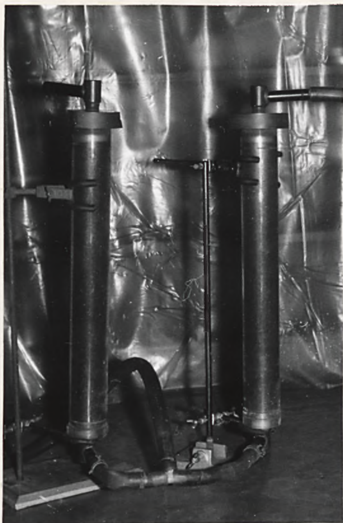
Rys. 12. Zestaw dwóch filtrów połączonych równolegle do adsorpcji zanieczyszczeń organicznych z wody wiślanej na węglu aktywnym.
