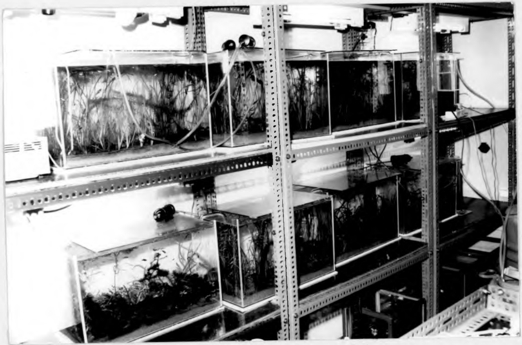
Fot. 1 Biofiltr służący do uzdatniania wody wodociągowej
