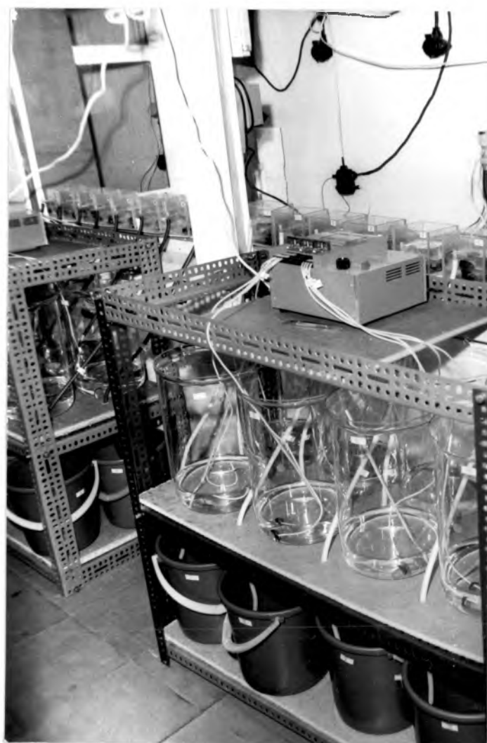
Fot. 2 Zestaw do badań toksyczności chronicznej komory testowe w głębi, system dozujący na pierwszym planie
