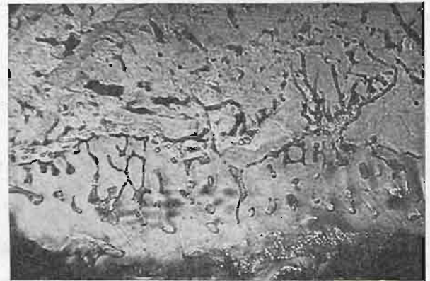
Rys. 7. Pow. 50 kr. Dalszy pokład naborowanej warstwy żelaza.
