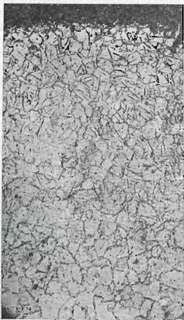
Rys. 1. Przekrój stali zwykłej, azotowanej. Wytraw. 4% kwasem azotowym. Powiększenie ok. 65 kr.
