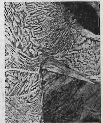
Rys. 11. Pas odkształconego materiału w plastycznym typie wióra z brzozi. Kąt natarcia 20°. Głębokość skrawania 0,25 mm.
