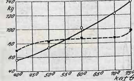
Rys. 4—6. Pomiary dynamometryczne. Wykresy nacisków prostopadłych i stycznych do wierzchu noża tokarskiego, w zależności od kąta zaostrenia. Posuwu 0,25 \text{ mm} ; prędkość skrawania 4 \text{ m/min} ; szerokość skrawania 2,5 \text{ mm} .
