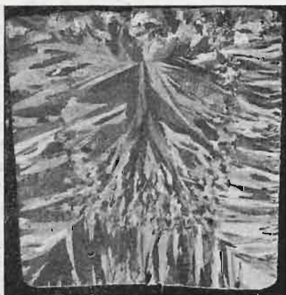
Rys. 7-a. Przekrój złe walcującego się pręta miedzianego, o budowie igielkowej. Wytraw. nadsiarczanem amonu 1:10. Ok. \frac{2}{3} wielk. rzecz.
