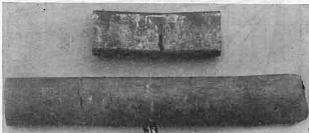
Rys. 6. Pręty miedziane, popękane przy walcowaniu (zmniejszone do \frac{1}{8} ).
