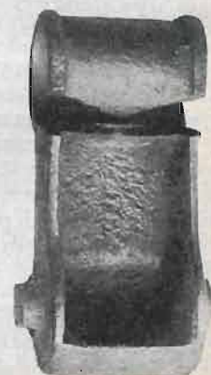
Rys. 12. Wieszak resorowy autobusów warszawskich (pęknięty).
