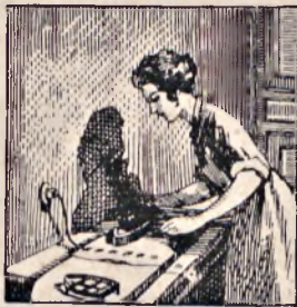
rys. 15. Złe oświetlenie: cień pada na ręce, przeszkadzając przy pracy
