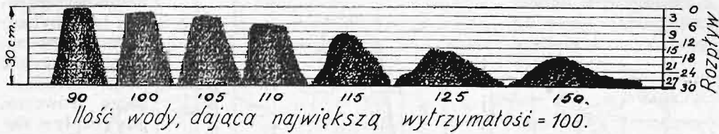
Rys. 16. Stopniowanie rozplywu w zależności od ilości wody w zaczynie.
