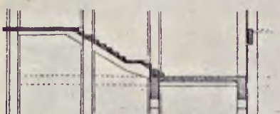
Rys. 3. Dylatacja i klatka schodowa Domu Akad.
