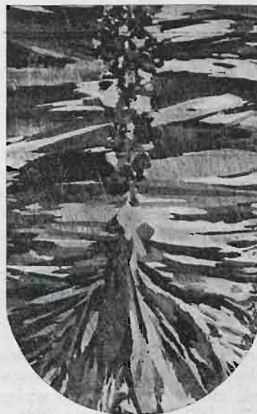
Rys. 48. Wielk. prawie rzecz. Układ igielkowy kryształów w pręcie z brązu aluminjowego, z krawędziami zaokrąglonymi. Wytraw. nadsiarczanem amonu 1:10.
