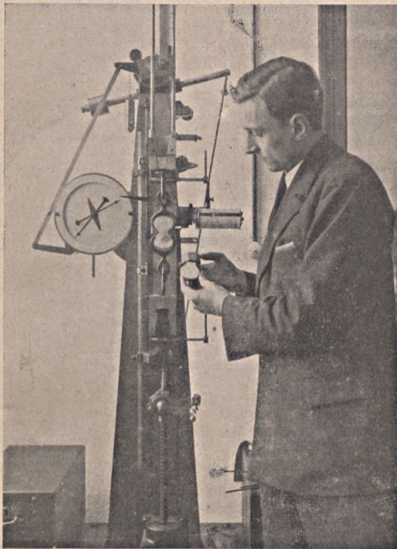
Rys. 18. Rozrywanie prób cementu tą samą maszyną, co na rys. 17.
