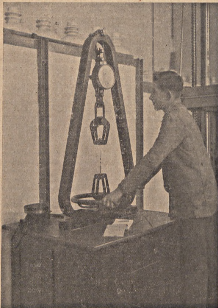
Rys. 15. Przyrząd dynamometryczny do badania wytrzymałości przewodników według § 3 „Przepisów technicznych na linie elektryczne napowietrzne”. Konstrukcje i wyrób Gródka.
