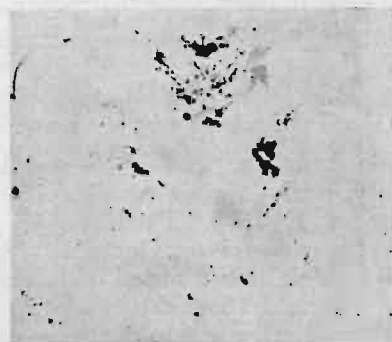
Rys. 25. Odbitki „kontaktowe“ z próbek aluminiowych, zawierających domieszki fosforu i siarki.
