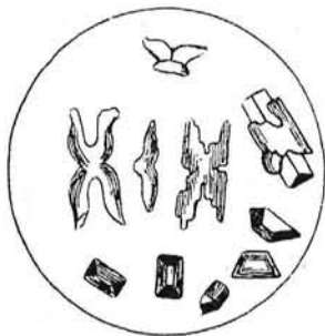
Fig. 6. Podwójny fosforan magnezu i amonu (wedł. Behrensa).
