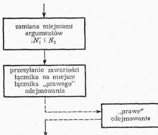
Rys. 4-8. Schemat blokowy podprogramu „lewego” odejmowania zmiennoprzecinkowego
