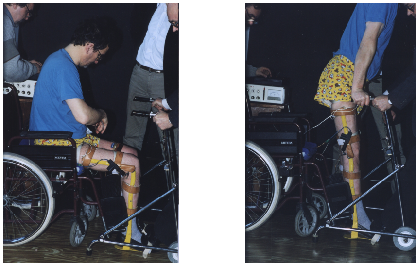
Ryc. 1.8. Aparat do wspomaganie czynności wstawania i chodu u osób z porażeniem kończyn dolnych. Widok po nałożeniu na kończynę pacjenta [45].
