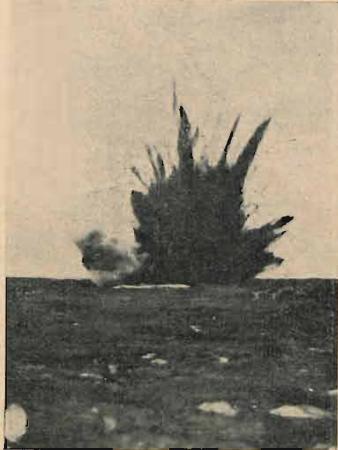
Rys. 16. Wybuch 60 kg. amonitu w czasie prac sejsmicznych na Podkarpaciu.
