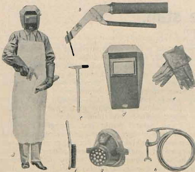
Fig. 40. Przybory po spawaniu. a) kompletny strój spawacza, b) kleszcze, c) młotek, d) maska, e) rękawiczki skórzane, f) szczotka, g) respirator, h) kabel.
