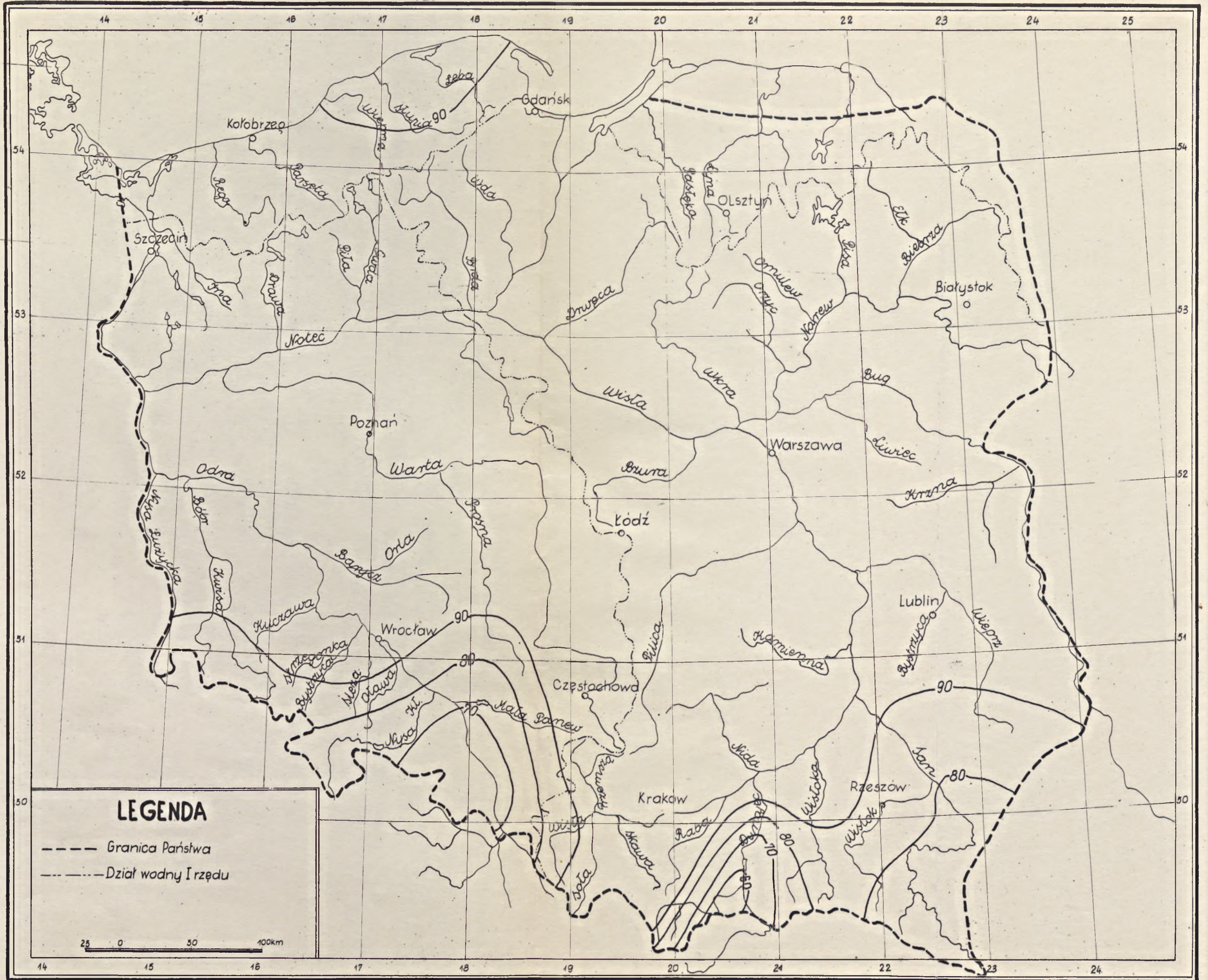
Rys. 15. Izolinie współczynnika \eta dla P=1\%
