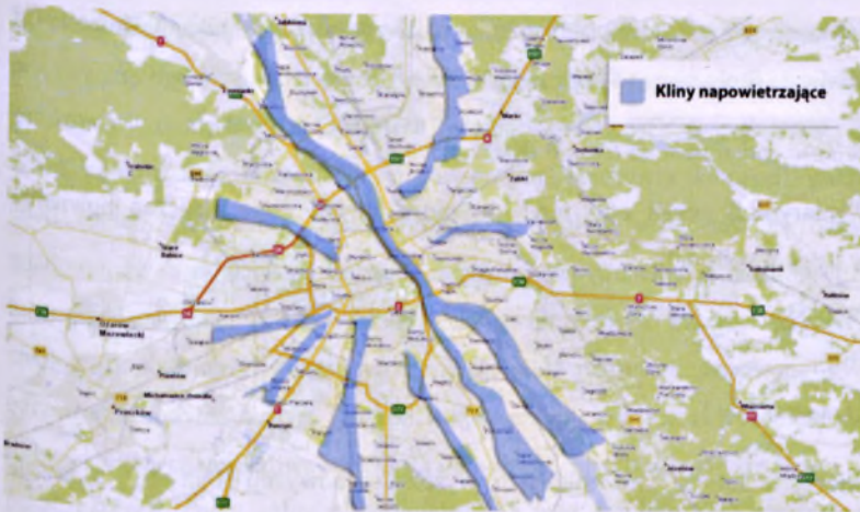
Rys. 3.4. Korytarze napowietrzające w Warszawie. Źródło: http://tvnwarszawa.tvn24.pl/
