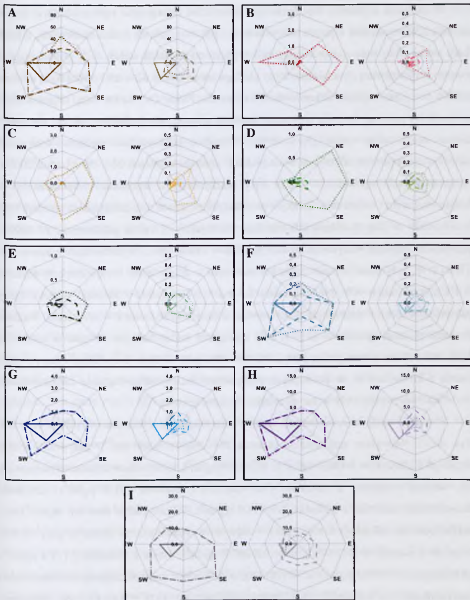
Rysunek 4.64. Różne stężenia zanieczyszczeń powietrza [ \mu\text{g}/\text{m}^3 ]: A) \text{PM}_{10} , B) As, C) Cd, D) Cr, E) Cu, F) Ni, G) Pb, H) Zn, I) suma jonów C_{\text{ions}} zmierzonych na stacji tła krajowego EMEP w Diabli Górze, maksymalnych (lewe panele) oraz uśrednionych (prawe panele) dla: całego roku 2010 (kropkowana linia), okresu styczeń – marzec 2010 r. (przerywana linia) oraz okresu epizodu 22 – 28 stycznia 2010 r. (ciągła linia). Źródło: Opracowanie własne na podstawie danych IOŚ uzyskanych w ramach PMŚ.
