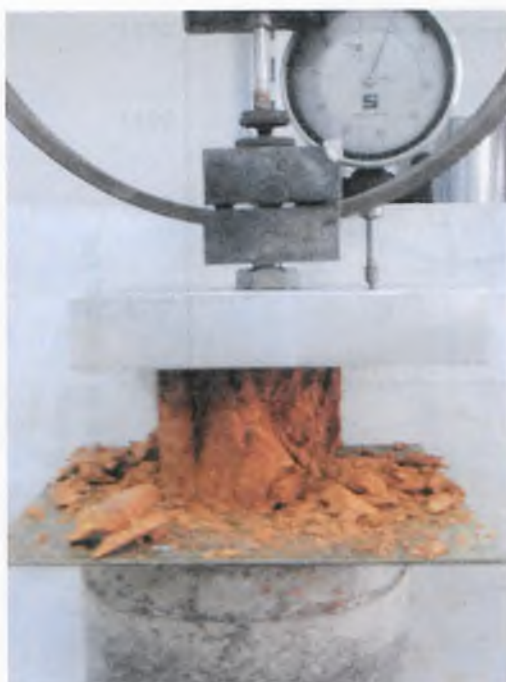
Fot. 8. Zniszczenie próbki osadów z dekarbonizacji wody po oznaczeniu wytrzymałości na ściskanie: partia III, seria C-S-1, w = 25,21\%
