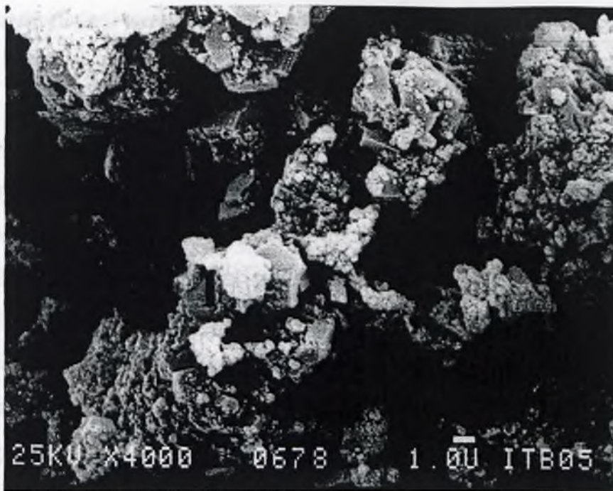
Fot. 2. Próbkę osadów z dekarbonizacji wody z EC Rzeszów, świeży przełam SEM, powiększenie 4000x
