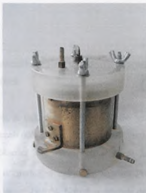
Fot. 14. Cylinder aparatu Proctora przystosowany do badania filtracji, o średnicy D=112,8 mm
