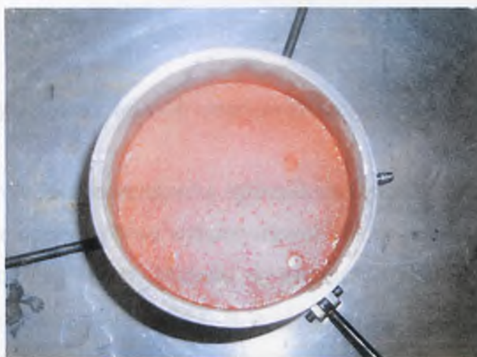
Fot. 18. Powierzchnia próbki osadów po filtracji długotrwałej 0,2 % roztworem NaOH (pH > 11)
