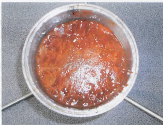
Fot. 19. Powierzchnia próbki osadów po filtracji długotrwałej 0,43 % roztworem HCl (pH < 3)
