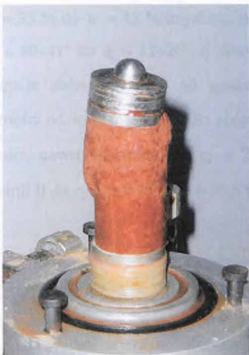
Fot. 6. Próbkę osadów po ścięciu w aparacie trójosiowego ściskania: partia II, w=42,98\% , \sigma_3=50 kPa
