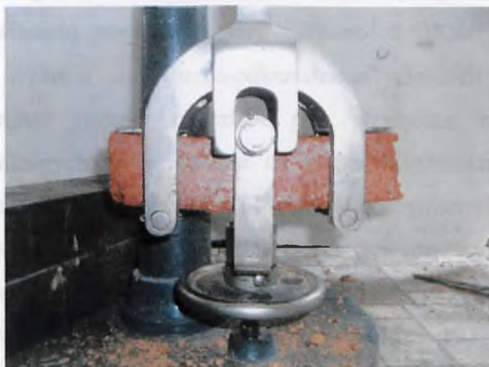
Fot. 12. Badanie wytrzymałości na rozciąganie przy zginaniu: partia III, seria R-S-G, w=36,73\%
