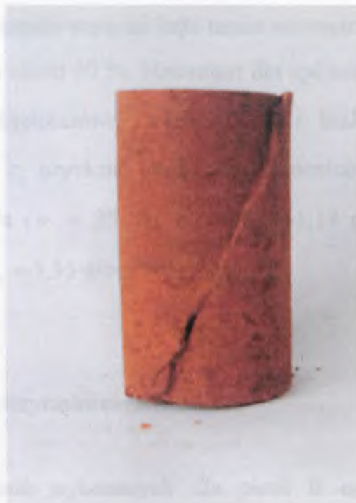
Fot. 7. Próbkę osadów po ścięciu w aparacie trójosiowego ściskania: partia I, w=33,73\% , \sigma_3=200 kPa
