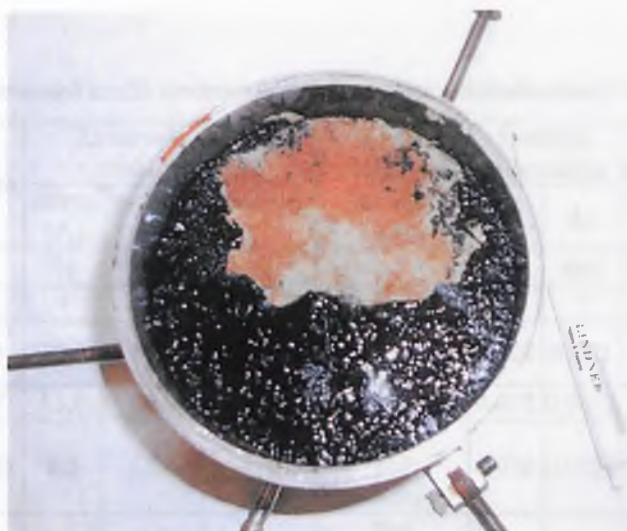
Fot.20. Górna powierzchnia próbki nr 2 (O2) po 3,5 miesiąca filtracji długotrwałej odciekami ze składowiska odpadów komunalnych
