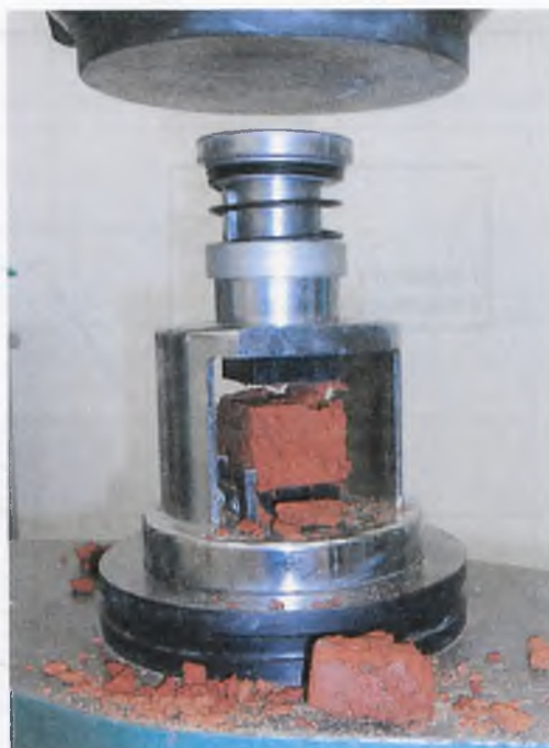
Fot. 9. Odształcenie próbki osadów z dekarbonizacji wody przy oznaczeniu wytrzymałości na ściskanie: partia III, seria C-S-G, w = 37,06\%
