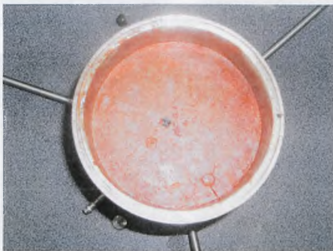
Fot. 16. Powierzchnia próbki osadów po filtracji długotrwałej wodą destylowaną
