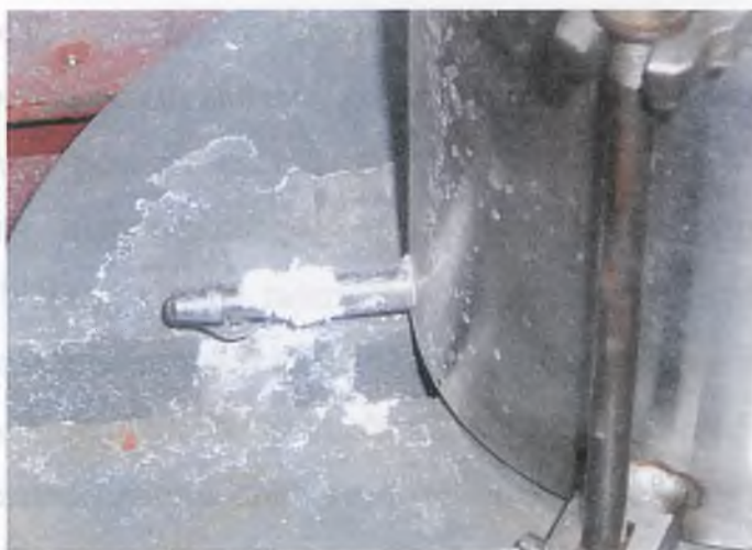
Fot. 15. Biały, krystaliczny osad powstały na odpływie aparatu, po około 80 dniach filtracji długotrwałej roztworem zasady sodowej
