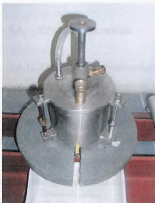
Fot. 13. Aparat do badania filtracji, o średnicy D=100 mm
