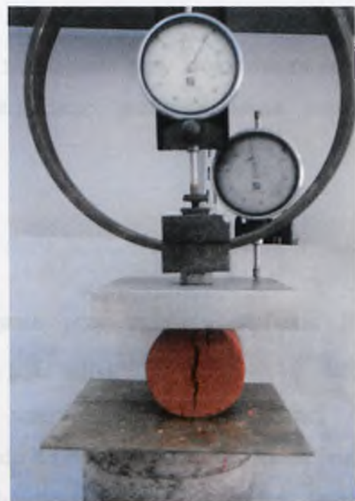
Fot. 11. Badanie wytrzymałości na rozciąganie przy rozłupywaniu: partia III, seria R-S-T, w = 35,52\%
