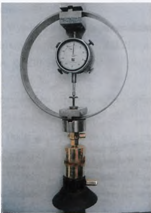
Fot. 10. Badanie wytrzymałości na rozciąganie metodą bezpośrednią: partia III, seria R-S
