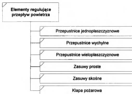
Rysunek 8.10. Klasy elementów regulujących przepływ powietrza.
