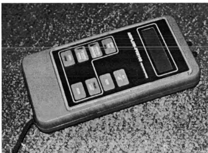
Rysunek 9.29. Mikromanometr Airflow – PVM 100.
