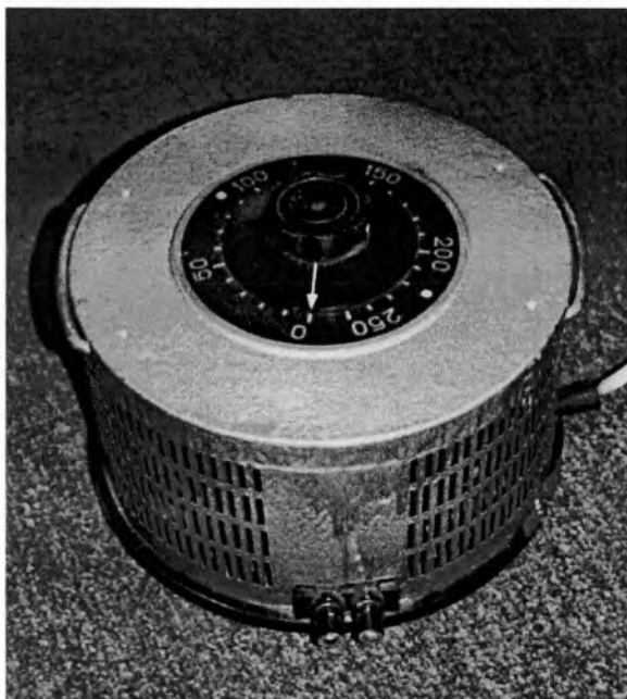
Rysunek 9.26. Widok autotransformatora sterującego wydatkiem wentylatora.
