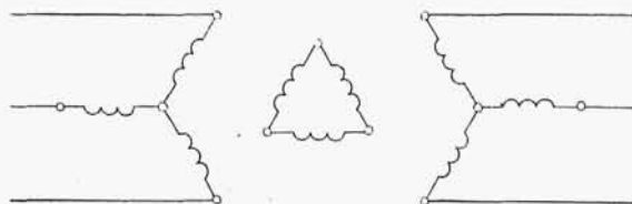
Rys. 3.19. Transformator o układzie połączeń gwiazda-gwiazda z dodatkowym uzwojeniem zamkniętym w trójkąt
