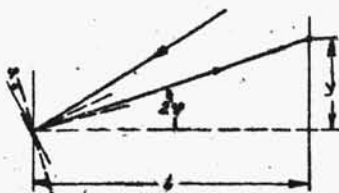
Rys. 49. Rysunek wyjaśniający zależność między kątem obrotu lusterka \varphi , a wychyleniem promienia świetlnego na oscylogramie
