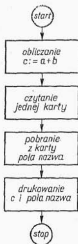
Rys. 3. Schemat blokowy fragmentu programu o podsieci liniowej
