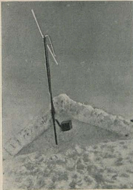
Rys. 18. Oblodzenie anteny po kilkunastominutowej pracy.
