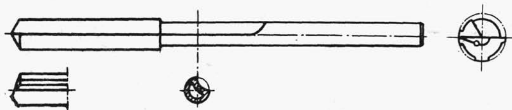
Rys.5.8. Wiertło lufowe z wewnętrznym doprowadzeniem chłodziwa
