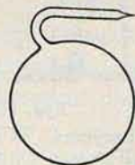
Rys. 63. Przyrząd Dumas do oznaczania gęstości pary cieczy.
