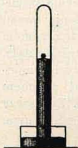
Rys. 47. Katalityczne działanie platyny na mieszaninę piorunującą.
