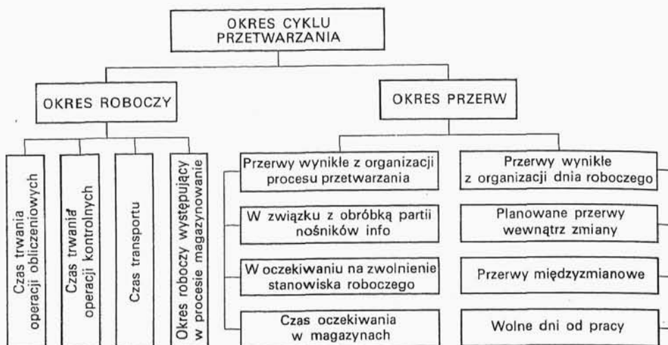
Rys. 22. Schemat struktury cyklu przetwarzania danych
