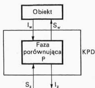
Rys. 13. Funkcje regulacyjne KPD w warunkach sterowania obiektem według jednego parametru
