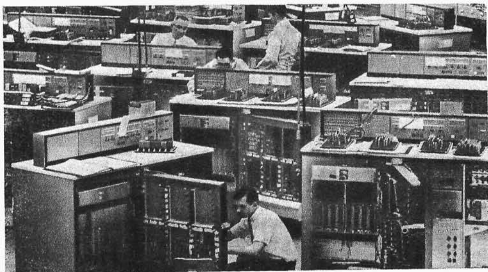
Rys. 5-19. Linia montażowa komputerów IBM 360/20 w San Jose, którą opuszcza dziennie 1 komputer
