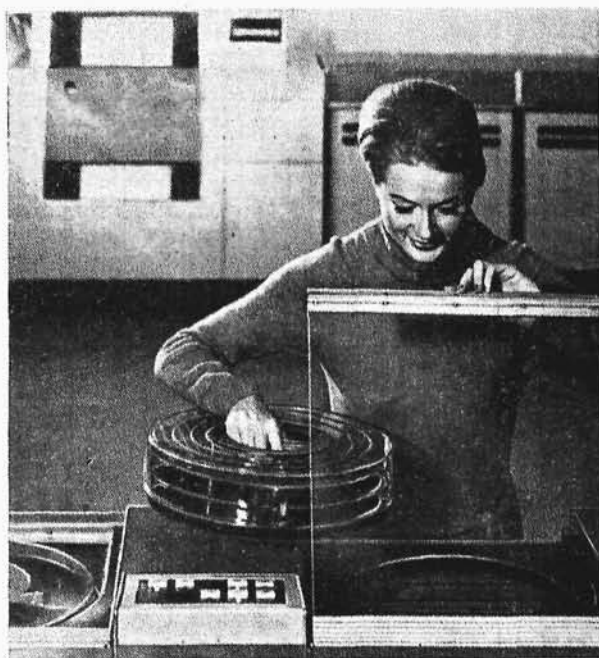
Rys. 5-12. Wymienny dysk (o pojemności 8,4 mln bajtów) komputera NCR Sentury 200
