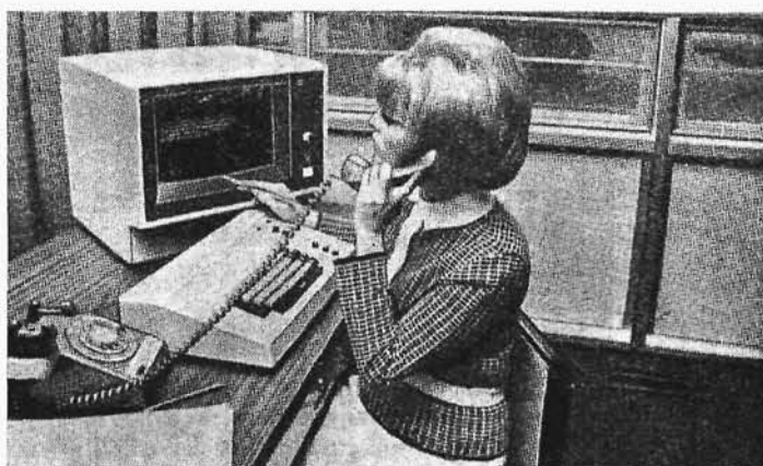
Rys. 5-33. Teledator w postaci ekranu z klawiaturą (IBM 2265)
