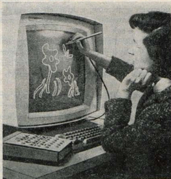
Ryc. 1.14. Urządzenie typu IBM+2250 do wprowadzania i wyprowadzania z komputera informacji zapisanej w postaci graficznej
