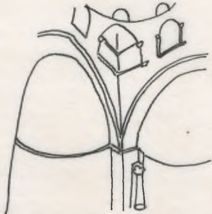
Rys. 102. Przejścia narożnikowe, trompes d'angle" z klasztoru "Cesarskiego" w Sohaq na Ławym brzegu Nilu z IV wieku z. Strygowskiego: "Klein Asien".
