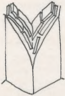
Rys. 101. Sklepienie krawpdczowe (d'arcate) Ceglane bez centrowania z M. Azji z IV w. wg. Choisy
