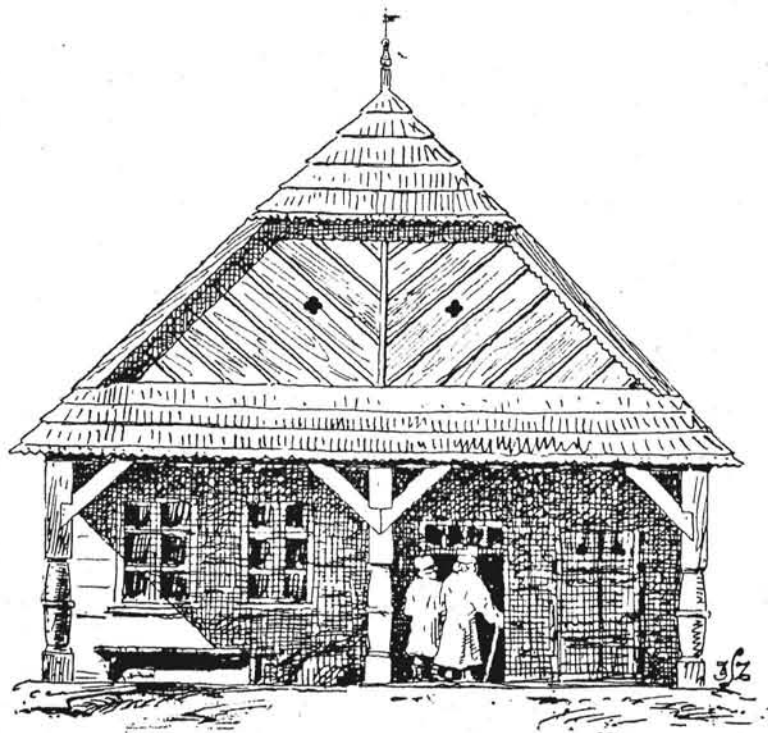
Rys: 49. Dom podcieniowy o dwóch krzesłach, z przysrzeszkiem górnym i dolnym. (Ciężkowice nad Białą).
