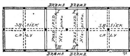
Rys. 97. Rzut poziomy stodoły założonej na 21. słupach, z dwoma sąsiekami całymi i z klepiskiem cztero-bramnym, w czwartaku umieszczonym.
