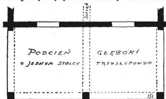
Rys. 26. Podcień głęboki „dwudzielny” o trzech słupach.
