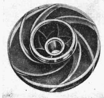
Rys. 12.12 Wirnik pompy odśrodkowej o przestrzennej krzywiznie łopatek wirnika z przezroczystą tarczą przednią umożliwiającą obserwację przepływu
