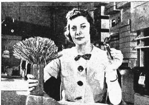
Ryc. 6. Zwykły kabel telefoniczny i kabel przyszłości „coaxial”
