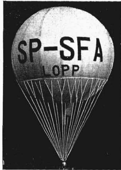
Ryc. 16. Pierwszy model polskiego balonu stratosferycznego. Ostatecznie zadecydowano, że kształt balonu przypominać będzie jajko, z szerszą częścią, zwróconą ku górze
