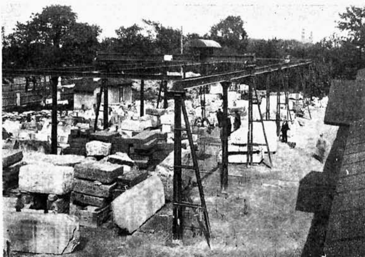
3. Fabryka w Kielcach. Skład bloków i płyt pod 10-tonowym kranem.
