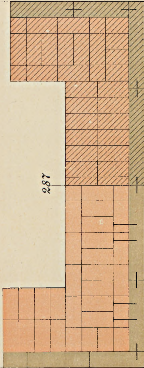
Cokoły z cegły, licowane kamiennymi płytami
