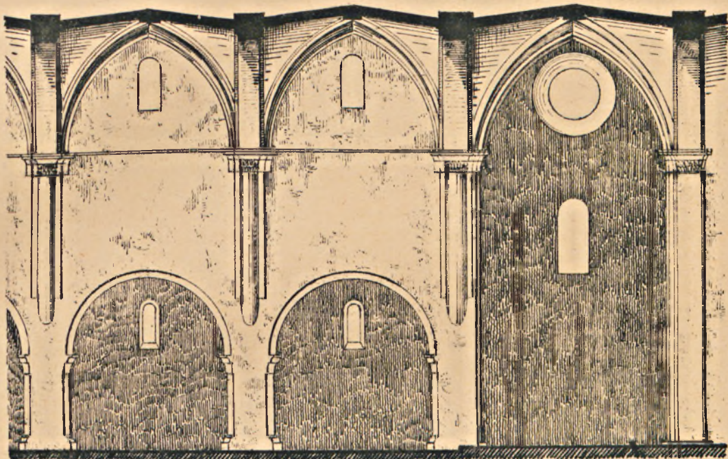
Rys. 1. Opactwo Sulejowski. - Część przekroju podł.: (Kwadrat skrzyżowania.)
