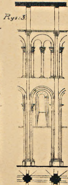
Rys. 3. Część przekr. południowego żyłego kościoła w Conques
