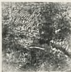
Żelwo o strukturze perlitycznej (bez ferrytu i cementytu). 500-krotne powiększenie.
