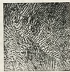
Patentowane żelwo „Perlit-Eutekton“ o wytrzymałości 35 kg/mm 2 (perlit i małe płatki grafitu, równomiernie rozmieszczone). 500-krotne powiększenie.
